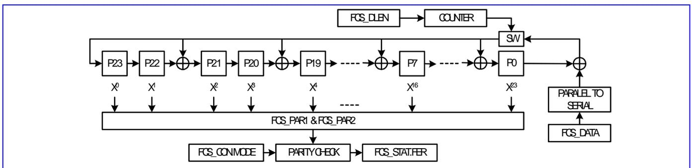
**Figure 42** FCS codec circuit.
